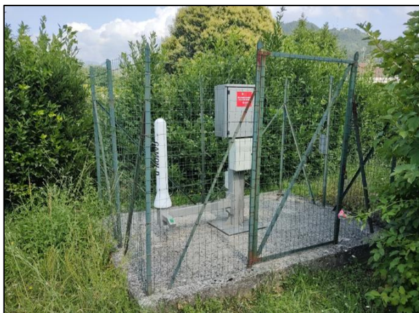
Figura 2 - Sonda di tipo dosimetrica (sinistra) e di tipo dosimetrica-spettrometrica (destra), della rete gamma, in fase di aggiornamento
